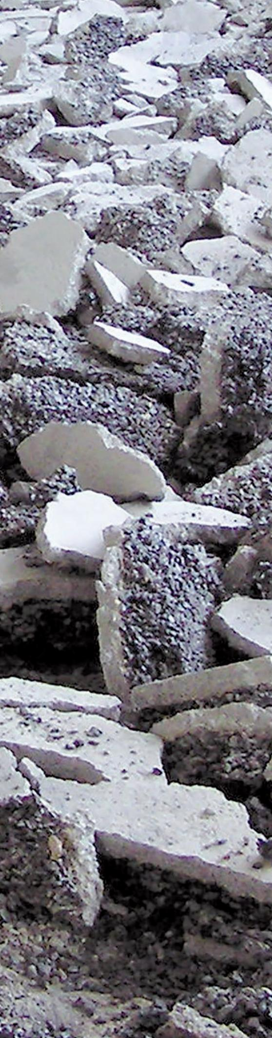
Mit Teeröl getränkter Unterlagsboden führte in einem Schulhaus zu kontaminierter Raumluft und Geruchsbelästigungen.
